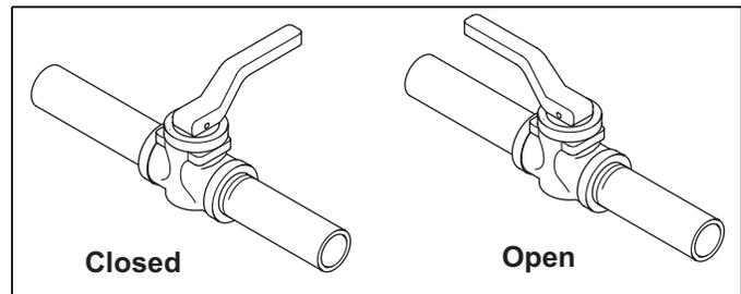
Figure 3.11. Valve Orientation
